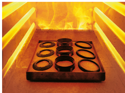
In einem Ofenprozess erhält die Oberfläche von Ceratanium® nicht nur die typischen Eigenschaften von Keramik, sondern auch ihre einzigartige mattschwarze Farbe
