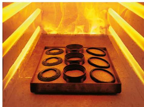
La cuisson au four confère à la surface du Ceratanium® les propriétés propres à la céramique mais aussi sa couleur noir mat typique
