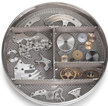
I singoli componenti del movimento vengono smontati
