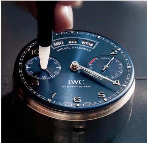
Nach erfolgreich absolvierten Tests und Funktionskontrollen werden Zifferblatt und Zeiger montiert
