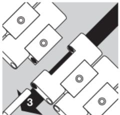
Ziehen Sie den vorstehenden Gelenkbolzen aus dem Armband (3). Jetzt ist das Band getrennt.
