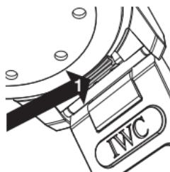
O seu Aquatimer Automático dispõe de um sistema patenteado de troca rápida da bracelete IWC que lhe permite mudar, facilmente e sem ferramenta, entre as variantes de bracelete disponíveis. Para remover a bracelete, pressione com a unha do polegar contra a alavanca de engate (1) que se encontra no lado de baixo da ligação da bracelete e empurre-a para fora.
