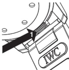
Su Aquatimer Automático dispone de un sistema patentado de cambio rápido de la correa o del brazalete IWC con el que fácilmente y sin ninguna herramienta se puede efectuar el cambio entre las diversas variantes de brazaletes y correas que se ofrecen. Para retirar el brazalete o la correa, pulse fuertemente con la uña del pulgar hacia afuera la palanca de trinquete (1) que se encuentra en la parte inferior de la junta del brazalete o de la correa.
