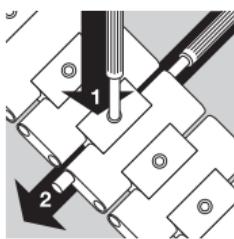
Abra o fecho de engate premindo as teclas laterais. Coloque a bracelete em cima de uma base firme, com o lado exterior virado para baixo. Para evitar arranhaduras na bracelete ou na base, convém meter um pano debaixo da bracelete. Com a ferramenta auxiliar inclusa, poderá agora
