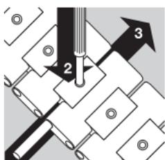
Mit dem beiliegenden Hilfswerkzeug drücken Sie nun den Fixierbolzen hinunter (2) und schieben gleichzeitig den Gelenkbolzen wieder bündig ins Armband zurück (3).
