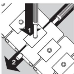
Abra el cierre desplegable apretando los pulsadores laterales. Coloque el brazalete sobre una base firme con su parte exterior hacia abajo. Para evitar que el brazalete y la base se rayen, coloque un paño por debajo. Con la herramienta adjunta, podrá presionar hacia abajo el perno de fijación
