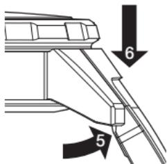
Kippen Sie nun das Band nach aussen (5) und drücken Sie gleichzeitig senkrecht von aussen auf den Bandanstoss, um den Mechanismus einrasten zu lassen (6).
