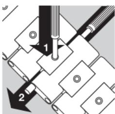
Apra la fibbia déployante facendo pressione sui tasti laterali. Distenda il bracciale con il lato superiore appoggiato su un supporto rigido. Per evitare di graffiare il bracciale e la superficie di appoggio, interponga un panno. Con l'apposito utensile in dotazione può ora spingere in basso il perno di fissaggio nel punto desiderato (1) spingendo contemporaneamente il perno di snodo verso l'esterno (circa 3 millimetri) con il secondo utensile (2).
