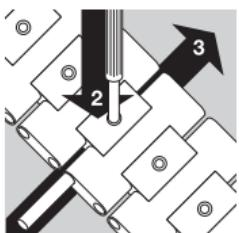
Ora con l'utensile allegato spinga in dentro il perno di fissaggio (2) e completi contemporaneamente l'inserimento nel bracciale del perno di snodo riportandolo a livello (3). Il perno di fissaggio deve essere reinserito a fondo, a livello del bordo superiore della maglia di ritenuta. Controlli che la posizione del perno di snodo sia corretta.
