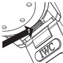
Ihre Aquatimer Automatic verfügt über ein patentiertes IWC-Armband-Schnellwechsel-System, mit dem mühelos und ohne Werkzeug zwischen den angebotenen Bandvarianten gewechselt werden kann. Drücken Sie zum Entfernen des Bandes kräftig mit dem Daumennagel den Rasthebel (1), der sich auf der Unterseite des Bandanstosses befindet, nach aussen.
