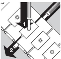
Öffnen Sie die Faltschliesse durch Drücken der seitlichen Tasten. Legen Sie das Band mit der Aussenseite nach unten auf eine feste Unterlage. Um ein Verkratzen von Band und Unterlage zu vermeiden, sollte ein Tuch untergelegt werden. Mit dem beiliegenden Hilfswerkzeug können Sie nun an der gewünschten Trennstelle den Fixierbolzen hinunterdrücken (1) und dabei den Gelenkbolzen mit dem zweiten Hilfswerkzeug seitlich etwa 3 Millimeter hinausschieben (2).
