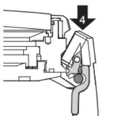
Pour fixer le bracelet, insérez l'encoche des cornes de bracelet de haut en bas dans la goupille de serrage du boîtier (4).
