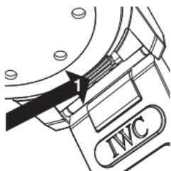
Votre Aquatimer Automatic est dotée d'un système breveté IWC de bracelet interchangeable. Celui-ci permet de monter aisément et sans outils un nouveau bracelet parmi les différents modèles proposés. Pour détacher le bracelet, appuyez fortement avec le pouce sur le levier d'arrêt (1) situé sur le côté inférieur des cornes de bracelet.
