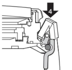
Per montare il bracciale agganci dall'alto la scanalatura dell'attacco nel perno della cassa (4).
