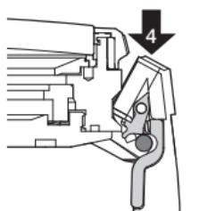
Zum Anbringen des Bandes hängen Sie die Einkerbung des Bandanstosses von oben in den Spannstift des Gehäuses ein (4).
