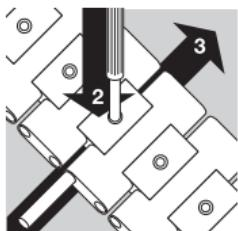
Au moyen de l'outil spécial fourni, enfoncez maintenant la cheville de fixation vers le bas (2) tout en réinsérant l'axe d'articulation dans le bracelet, en prenant soin de bien l'aligner (3).
