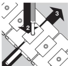
Com a ferramenta auxiliar inclusa, empurre agora o pino de fixação para baixo (2), empurrando ao mesmo tempo o pino articulado para dentro até ficar nivelado com a bracelete (3).
