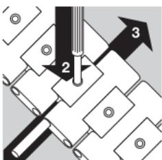
Con la herramienta adjunta, presione hacia abajo el perno de fijación (2) y, al mismo tiempo, vuelva a insertar a ras el perno articulado en el brazalete (3).
