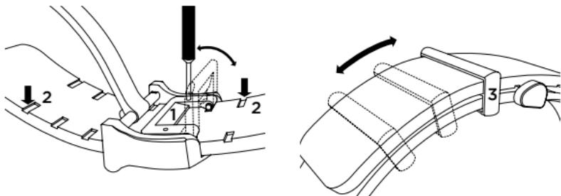
**Sicherheitshinweis:** Achten Sie darauf, dass der Rasthebel des Klemmverschlusses immer fest verschlossen ist, um ein unbeabsichtigtes Herausrutschen des Bandes zu vermeiden.
