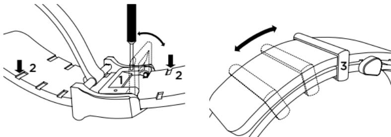
**Aviso de seguridad:** asegúrese de que la palanca de bloqueo del cierre de apriete esté siempre bien cerrada para evitar que el brazalete se deslice sin querer.
