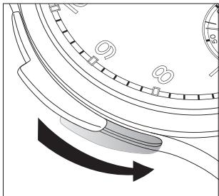
依图示启动报时滑掣。您必需经常要完全压下滑掣，否则无法启动报时装置。在「顺利报时或鸦雀无声」的原则下，我们确保腕表不会错误报时。接着您便可让滑掣返回原来位置。
