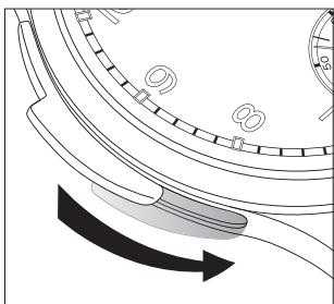
リピータースライドは、左図のように動かします。常に奥までしっかりと押してください。押し方が不十分な場合、リピーターは作動しません。この「オール・オア・ナッシング」の法則により、時計が誤った時刻を鳴らすことを未然に防ぎます。その後、スライドを元の位置に戻します。
