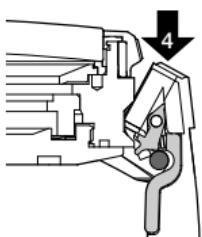
Zum Anbringen des Bandes hängen Sie die Einkerbung des Bandanstosses von oben in den Spannstift des Gehäuses ein (4).
