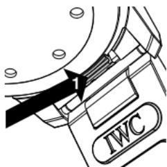
Su Aquatimer Automático 2000 dispone de un sistema patentado de cambio rápido de la correa o del brazalete IWC con el que fácilmente y sin ninguna herramienta se puede efectuar el cambio entre las diversas variantes de brazaletes y correas que se ofrecen. Para retirar el brazalete o la correa, pulse fuertemente con la uña del pulgar hacia afuera la palanca de trinquete (1) que se encuentra en la parte inferior de la junta del brazalete o de la correa.
