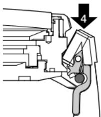
Per montare il bracciale agganci dall'alto la scanalatura dell'attacco nel perno della cassa (4).
