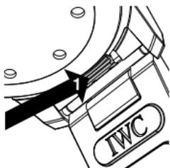
Il suo Aquatimer Automatic 2000 è dotato di un sistema brevettato di sostituzione rapida del cinturino che consente di effettuare questa operazione comodamente e senza l'ausilio di utensili. Stacchi il bracciale premendo verso l'esterno con l'unghia del pollice la levetta a scatto (1) che si trova sulla parte inferiore dell'attacco del bracciale.
