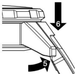
Faites basculer maintenant le bracelet vers l'extérieur (5) tout en appuyant de l'extérieur verticalement sur les cornes pour encliquer le mécanisme (6).
