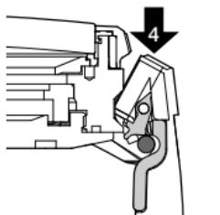
Pour fixer le bracelet, insérez l'encoche des cornes de bracelet de haut en bas dans la goupille de serrage du boîtier (4).
