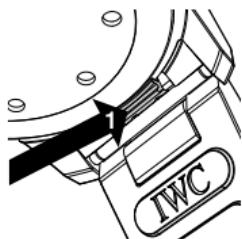
O seu Aquatimer Automático 2000 dispõe de um sistema patenteado de troca rápida da bracelete IWC que lhe permite mudar, facilmente e sem ferramenta, entre as variantes de bracelete disponíveis. Para remover a bracelete, pressione com a unha do polegar contra a alavanca de engage (1) que se encontra no lado de baixo da ligação da bracelete e empurre-a para fora.
