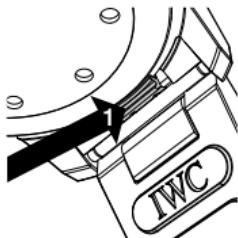
Ihre Aquatimer Automatic 2000 verfügt über ein patentiertes IWC-Armband-Schnellwechsel-System, mit dem mühelos und ohne Werkzeug zwischen den angebotenen Bandvarianten gewechselt werden kann. Drücken Sie zum Entfernen des Bandes kräftig mit dem Daumennagel den Rasthebel (1), der sich auf der Unterseite des Bandanstosses befindet, nach aussen.
