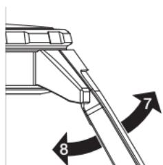
Dopo qualsiasi operazione di sostituzione si accerti che entrambe le metà del cinturino siano inserite nel proprio alloggiamento premendole con forza verso l'alto (7) e verso il basso (8).
