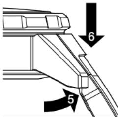
Incline después el brazalete o la correa hacia afuera (5) y, al mismo tiempo, desde fuera, ejerza presión en vertical sobre la junta para que el mecanismo quede encajado (6).
