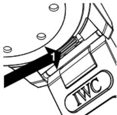
Votre Aquatimer Automatic 2000 est dotée d'un système breveté IWC de bracelet interchangeable. Celui-ci permet de monter aisément et sans outils un nouveau bracelet parmi les différents modèles proposés. Pour détacher le bracelet, appuyez fortement avec le pouce sur le levier d'arrêt (1) situé sur le côté inférieur des cornes de bracelet.
