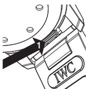
Il suo Aquatimer Calendario Perpetuo Digitale Data e Mese è dotato di un sistema brevettato IWC di sostituzione rapida del cinturino che consente di effettuare questa operazione comodamente e senza l'ausilio di utensili. Stacchi il bracciale premendo verso l'esterno con l'unghia del pollice la levetta a scatto (1) che si trova sulla parte inferiore dell'attacco del bracciale.
