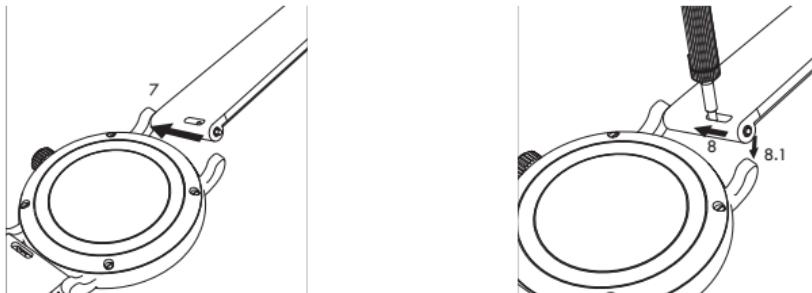
Для під'єднання ремінця вставте пружинну шпильку стороною, на якій немає штифта, в отвір на внутрішній стороні вушка для кріплення (7).
