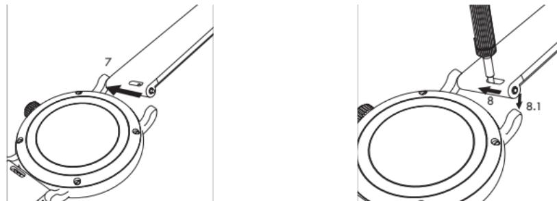
Для присоединения ремешка установите пружинистый стержень стороной, на которой нет штифта, в отверстие на внутренней стороне ушка крепления (7).
