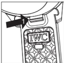
Pour détacher le bracelet, appuyez avec le pouce sur la languette de fixation (1) située sur le côté inférieur de l'attache du bracelet.
