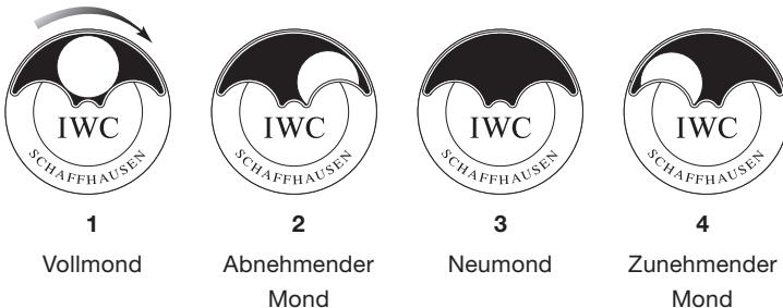
Die Mondphasenanzeige wird durch das Kalendarium der Uhr automatisch richtig eingestellt. Die Mondphasenanzeige ist somit immer korrekt. Das Übersetzungsverhältnis ist so präzise, dass die Anzeige erst nach 577 Jahren um einen einzigen Tag abweicht.
