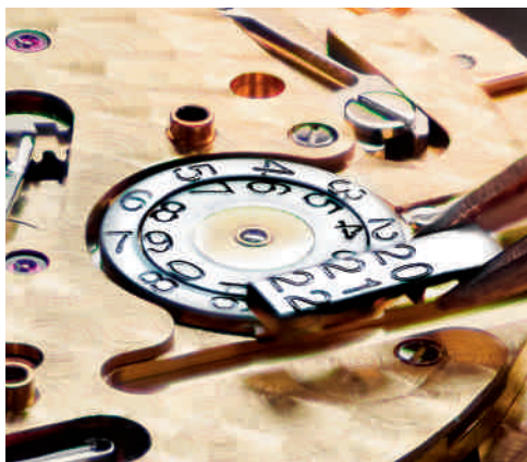
Пластина указателя века вечного календаря запрограммирована до 31 декабря 2299 года
