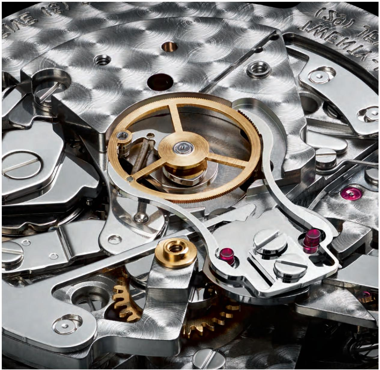
Avec le mécanisme de rattrapante, la rattrapante rejoint l'aiguille du chronographe pour cheminer avec elle
