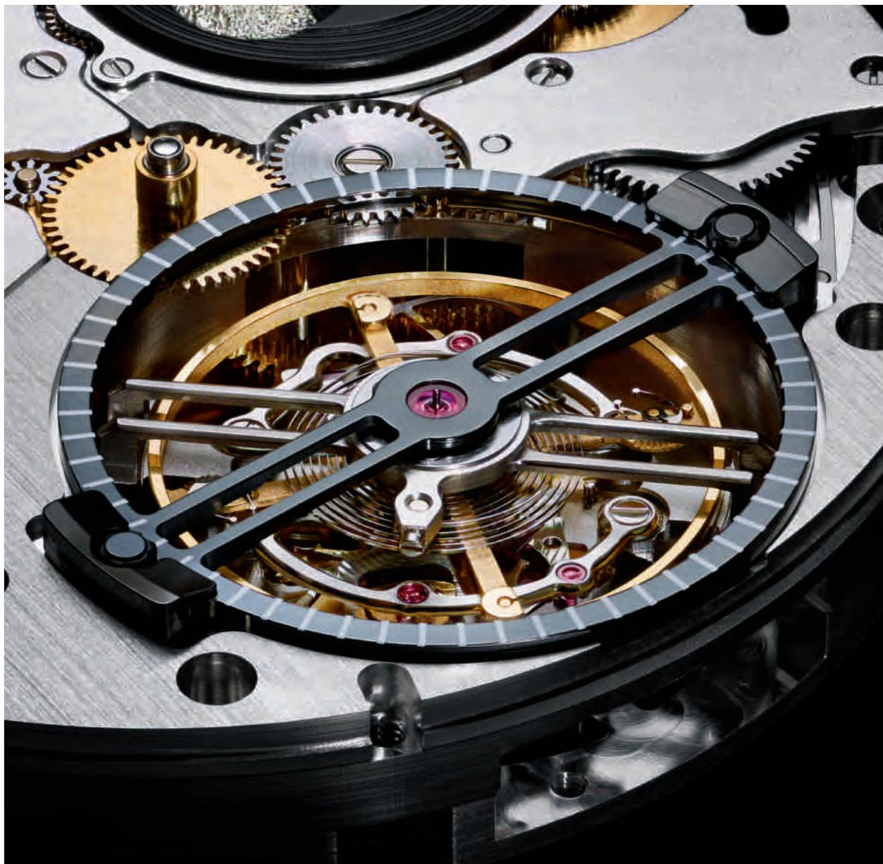
Una máquina de precisión: tourbillon con mecanismo de fuerza constante patentado
