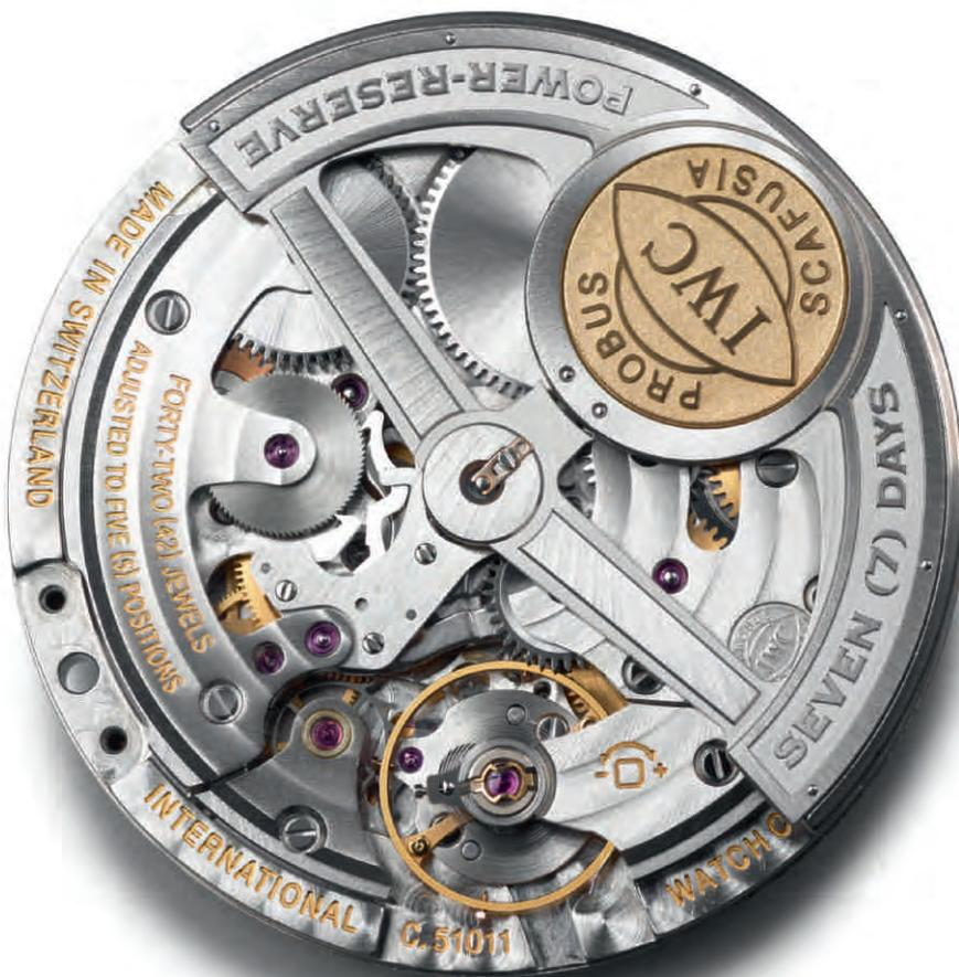
Il voluminoso calibro di manifattura 51011 con rotore su supporto elastico e sistema di ricarica a cricchetti di Pellaton
