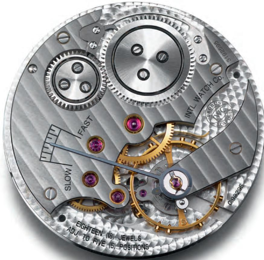
El calibre de la manufactura 98295, el movimiento de base del Portugués Repetición de Minutos con índice de raqueta extralargo para un ajuste preciso de la longitud efectiva de la espiral
