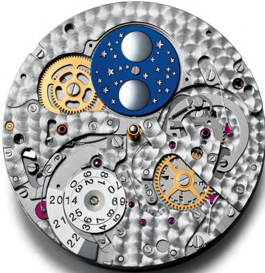
El movimiento de la manufactura IWC 51613 visto desde el lado de la esfera. Se pueden apreciar la indicación de las fases de la Luna y los discos para la indicación del año con cuatro cifras
