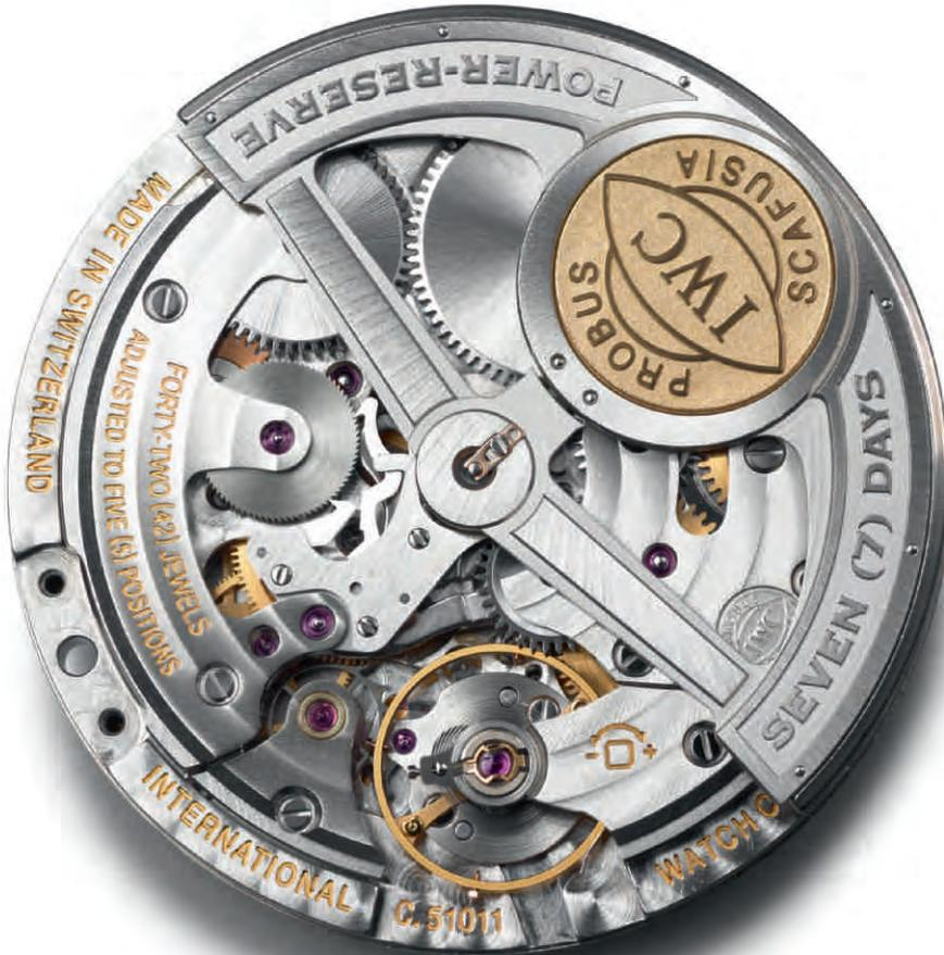
El voluminoso calibre de la manufactura 51011 con rotor de soporte elástico y cuerda de trinquete Pellaton
