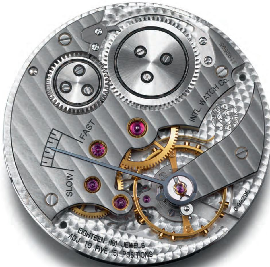
Das Manufakturkaliber 98295, das Grundwerk der Portugieser Minutenrepetition mit überlangem Rückzeiger zur präzisen Einstellung der wirksamen Spirallänge
