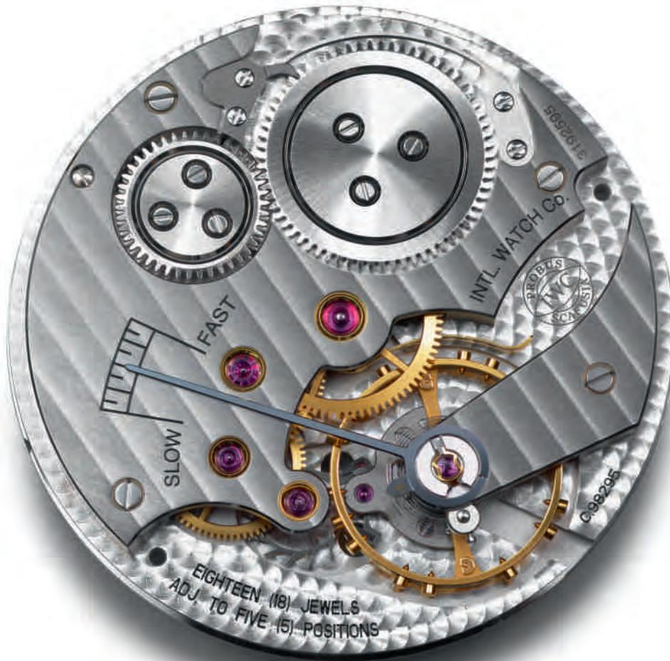
El calibre de la manufactura 98295, el movimiento de base del Portugieser Repetición de Minutos con índice de raqueta extralargo para un ajuste preciso de la longitud efectiva de la espiral
