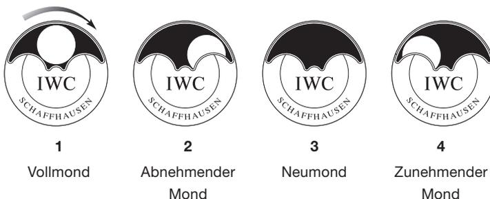
Die Mondphasenanzeige wird durch das Kalendarium der Uhr automatisch richtig eingestellt. Die Mondphasenanzeige ist somit immer korrekt. Das Übersetzungsverhältnis ist so präzise, dass die Anzeige erst nach 577 Jahren um einen einzigen Tag abweicht.
